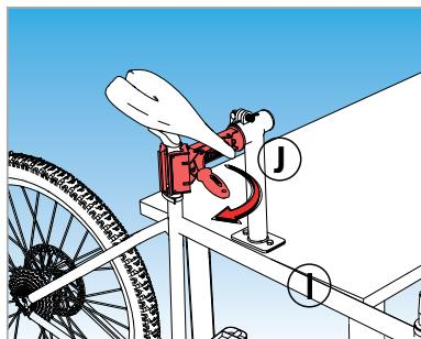
**Firmly hold bike frame (I). Flip handle (J) to quickly release tube from jaws.** • Trdno primite okvir kolesa (I). Obrnite ročaj (J) za hitro sprostitev cevi iz čeljusti orodja.
