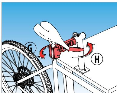
**Adjust opened jaws (G) to seatpost or bike tube. Turn handle (H) until jaws firmly grabs the tube.** • Nastavite odprto čeljust (G) sedežno oporo ali cev okvirja. Obrnite ročaj (H) dokler čeljust ne zajamejo celotne cevi.
