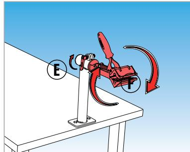
**To adjust bike stand head position, release lever (E) and adjust/rotate the head (F).** • Za nastavitev glave stojala sprostite vzvod (E) in nato nastavite željeno pozicijo (F) glave stojala.
